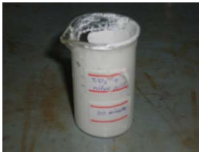
Figure 7(b) TiO 2 -ZrO 2 paste
